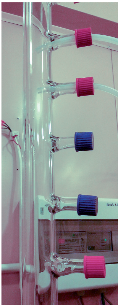
Fot. 6. Czerpnia po czyszczeniu
