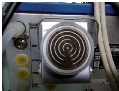
Fot. 1. Zdjęcie filtra przed jego wymianą, wykonane po miesięcznej eksploatacji analizatora w okresie zimowym, czyli wtedy, kiedy występuje największe zanieczyszczenie powietrza
