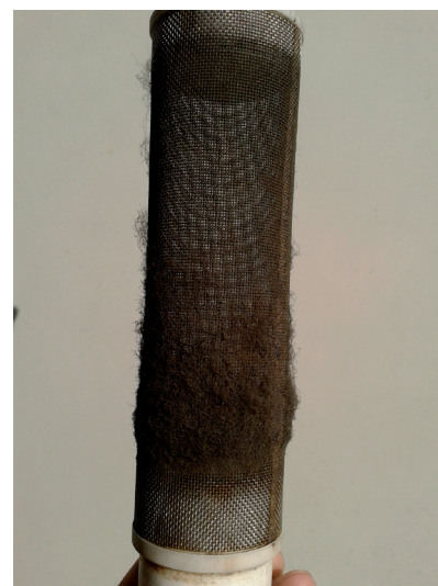
Fot. 3. Zdjęcie filtra wlotowego powietrza, wykonane przed czyszczeniem, po dwumiesięcznym okresie eksploatacji, maj – czerwiec, okres pylenia drzew
