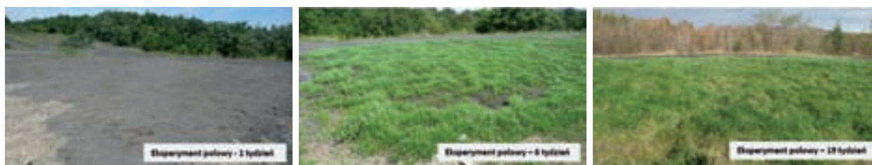
Fot. 1. Eksperyment pilotażowy – poletko badawcze (1-19 tygodni po ułożeniu warstwy rekultywacyjnej i obsiewie)
