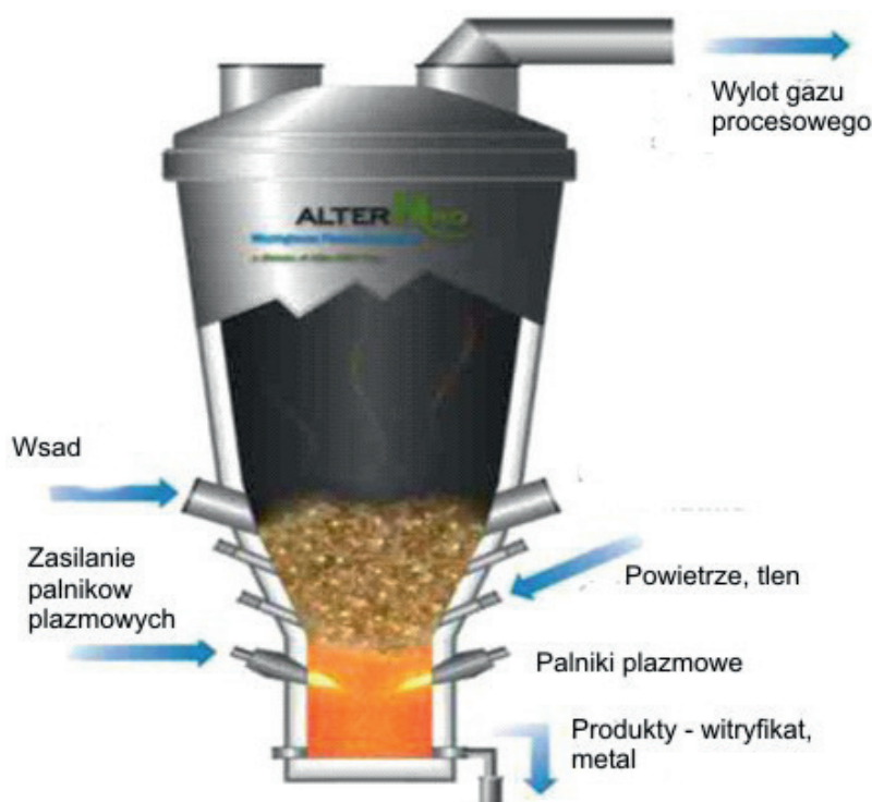
Rys. 3. Reaktor wysokotemperaturowego zgazowania odpadów z palnikami plazmowymi [5].
