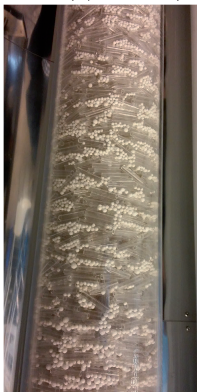
Fot. 1. Wnętrze reaktora wypełnionego katalizatorem (białe kule) i elementami szklanymi dla zwiększenia efektywności dystrybucji światła; ze zbiorów autora.
