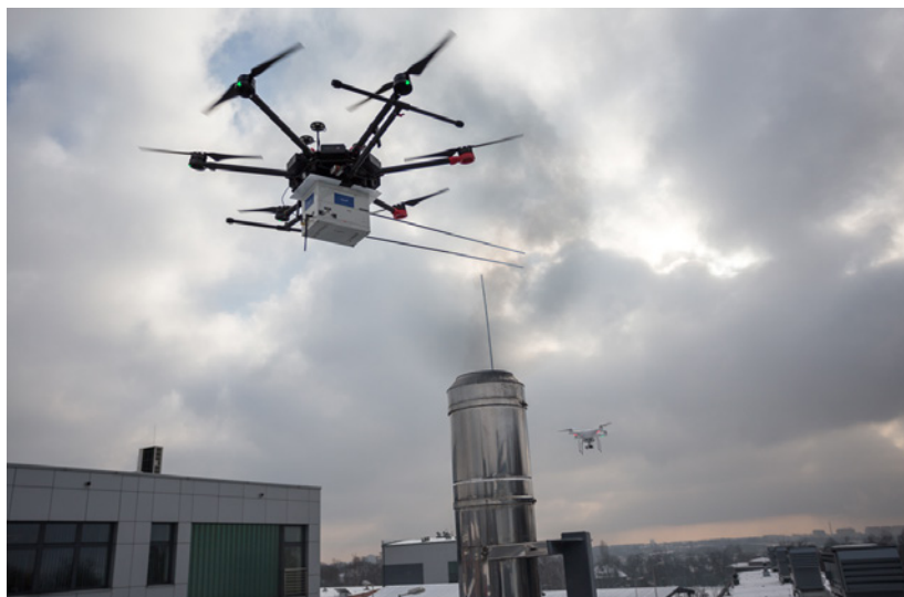
Instytut wykorzystuje drony do pomiarów stężeń zanieczyszczeń pyłowo – gazowych
