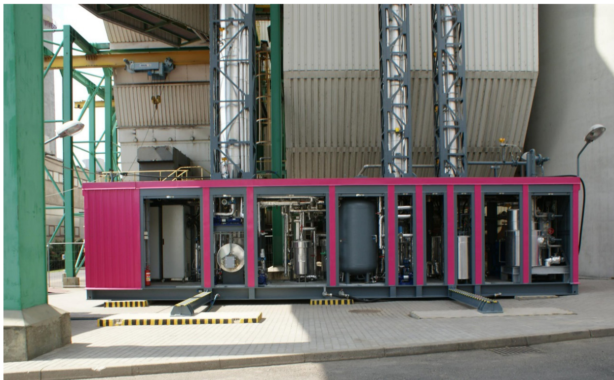
Przełazna instalacja pilotowa (podczas testów w Tauron Wytwarzanie S.A. w Łaziskach) do aminowego usuwania CO 2 ze spalin przemysłowych.
