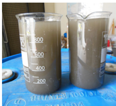
Fot. 4. Ścieki pochodzące ze stacji mycia
