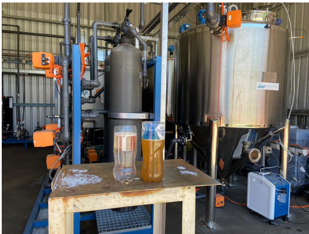
Fot. 3. Degradacja glifosatu w urządzeniu pracującym w Perth w Zachodniej Australii (w lewym pojemniku woda oczyszczona, w prawym zanieczyszczony ściek).
